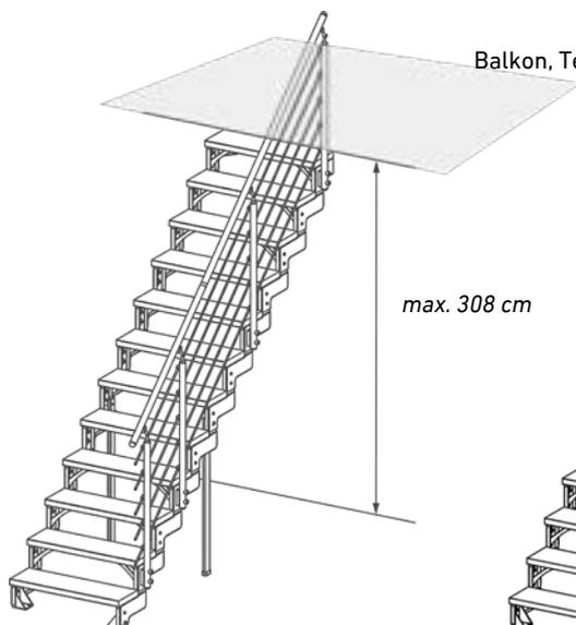
Abbildung 2: 2-14 Stufen/15 Steigungen
