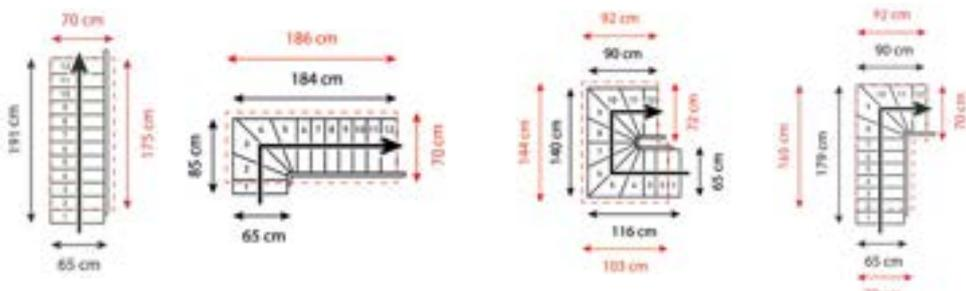
**Beispiel Dublin, Treppenbreite 65 cm:** Kommt eine Stufe hinzu, verändert sich die Ausladung und Sie addieren 15,7 cm. Entfällt eine Stufe, ziehen Sie entsprechend 15,7 cm von der Ausladung ab.
