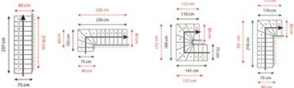
**Beispiel Cork, Treppenbreite 75 cm:** Kommt eine Stufe hinzu, verändert sich die Ausladung und Sie addieren 15,7 cm. Entfällt eine Stufe, ziehen Sie entsprechend 15,7 cm von der Ausladung ab.
