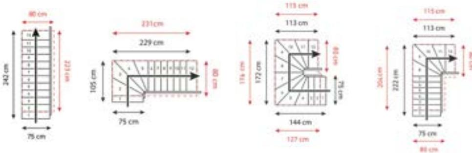
**Beispiel Hamburg, Treppenbreite 75 cm:** Kommt eine Stufe hinzu, verändert sich die Ausladung und Sie addieren 19,5 cm. Entfällt eine Stufe, ziehen Sie entsprechend 19,5 cm von der Ausladung ab.
