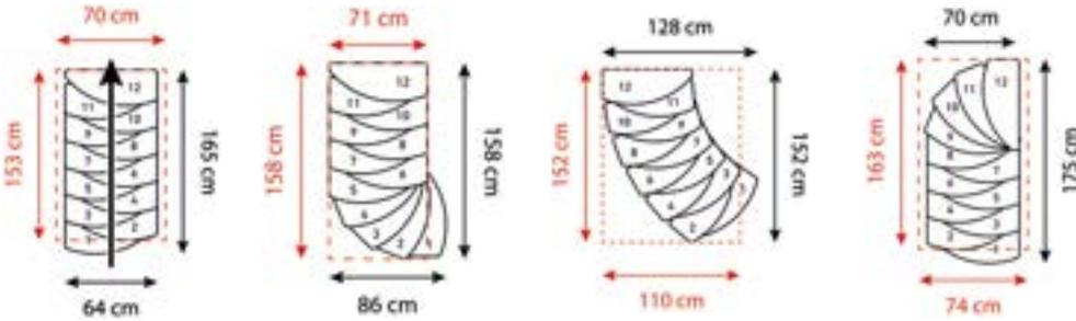
**Beispiel 12-stufige Berlin/Basel, Treppenbreite 64 cm:** Kommt eine Stufe hinzu, verändert sich die Ausladung und Sie addieren 13 cm. Entfällt eine Stufe, ziehen Sie entsprechend 13 cm von der Ausladung ab.
