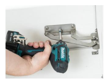
**11.** Die Gasdruckfedern mit Kasten und Deckel verbinden und mit den beiliegenden Sprengringen sichern.
